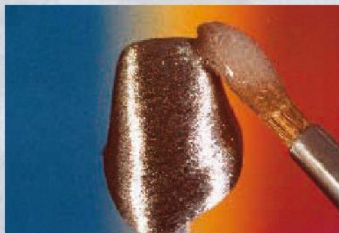
L'applicazione della sostanza gelatinosa per il secondo trattamento di inertizzazione sotto stato vetroso dopo la rifinitura di superficie prima del rivestimento estetico ceramico.
